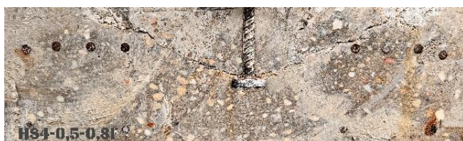
Vista da formação do cone de arrancamento no sentido transversal da região de embutimento da série HS4-0,8F
