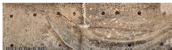
Vista da formação do cone de arrancamento no sentido transversal da região de embutimento da série HS3-0,8D
