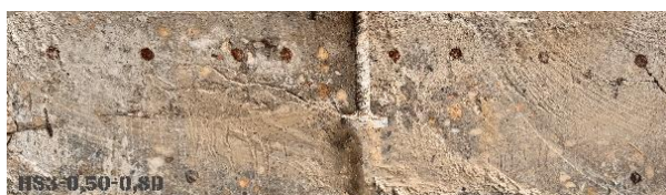
Vista da formação do cone de arrancamento no sentido transversal da região de embutimento da série HS3-0,8D
