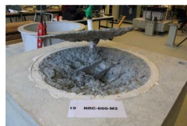
e) Espécimes ensaiados com armadura superficial
