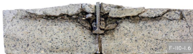
Figura 2-27. Resistência ao arrancamento de conectores instalados em concreto fissurado e não fissurado (FERREIRA et al. , 2021)
